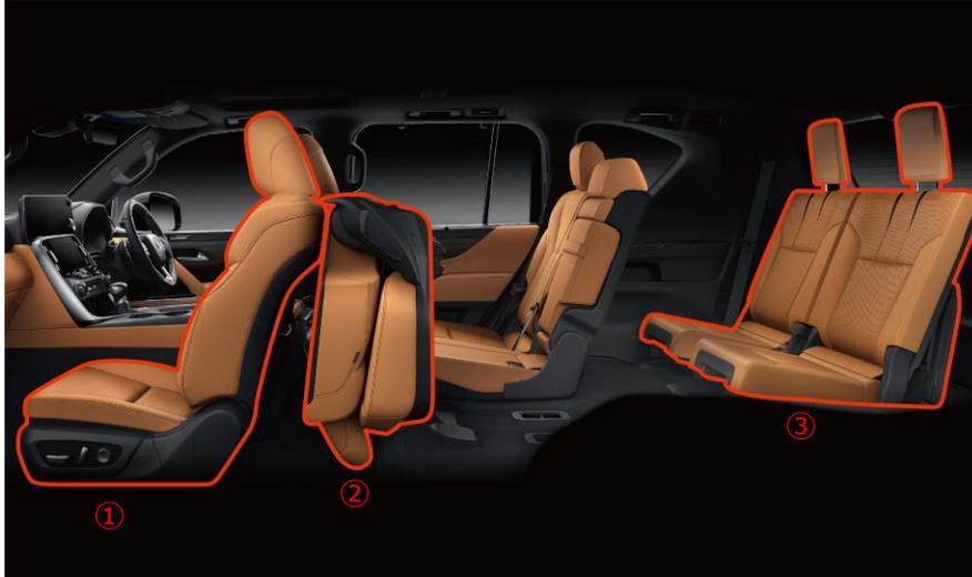
ラゲージスペース拡大機構は、ラゲージルームにあるスイッチを操作するだけで、②セカンドシート、③サードシートが自動で格納され、ラゲージルームの拡大を可能にします。
