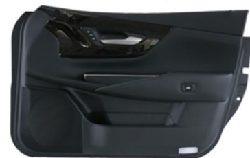
【図 3】 「高耐衝撃プラスチック」を適用した ドアトリム（トヨタ クラウン）
