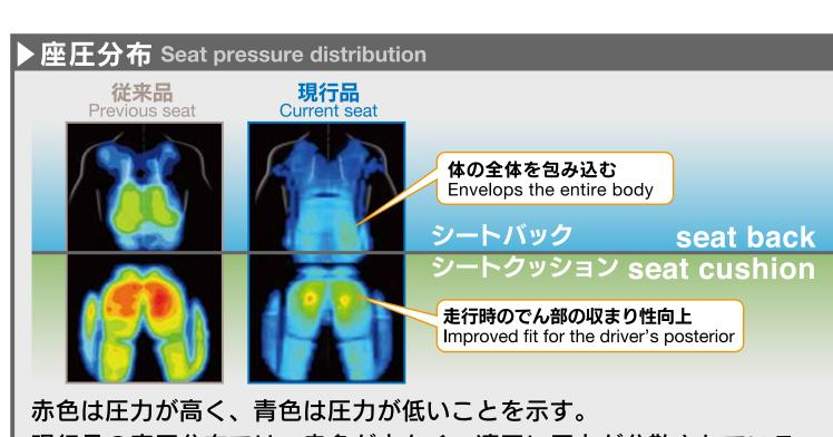
現行品の座圧分布では、赤色が少なく、適正に圧力が分散されている。
