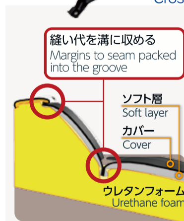
被せ工法 Covering Method
