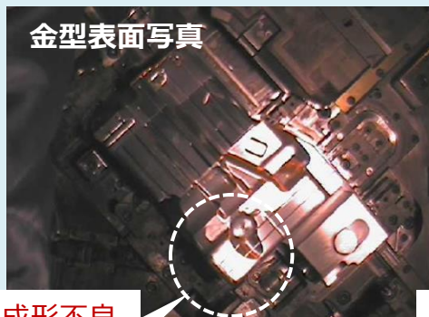
金型表面写真 成形不良 部位
