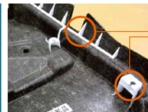
樹脂ブラケット (裏面構造物) Resin bracket (Backside structure)
