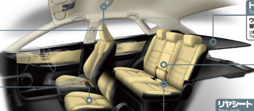
ウレタン材料を採用し、軽量化を実現。 容易に着脱でき、床下に収納可能。
