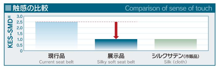
※ KES-SMD: 織物風合い試験KESの表面粗度の指標 ※ KES-SMD: Average deviation of surface roughness data
