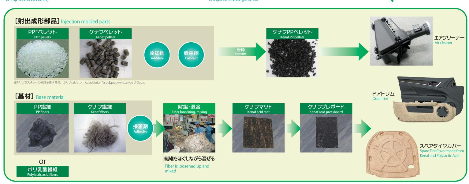
**ポリ乳酸とは** でんぷんを発酵させてできる乳酸を原料とした、植物由来のプラスチック。 生分解性プラスチックの素材として関心が高く、環境にもやさしいと注目されている。 **Polylactide** A plant-derived plastic, for which the raw material is a lactic acid made by fermentation of starch. It is highly regarded as a biodegradable plastic and is attracting attention as an environmentally friendly product.
