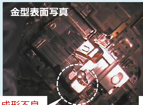
金型表面写真 成形不良 部位
