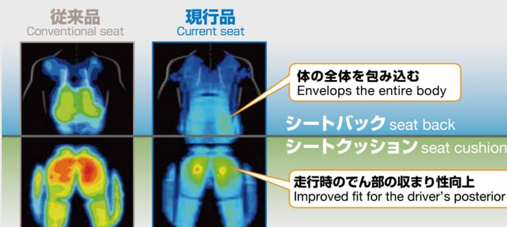
赤色は圧力が高く、青色は圧力が低いことを示す。現行品の座圧分布では、赤色が少なく、適正に圧力が分散されている。
