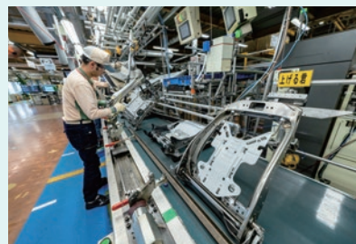
作業時の姿勢が悪く負荷が高かった。フレームを起き上がらせることで負担を軽減する「上げる君」を導入
