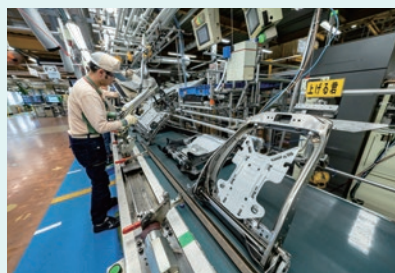
作業時の姿勢が悪く負荷が高かった。フレームを起き上がらせることで負担を軽減する「上げる君」を導入
