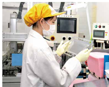
防塵、温度など徹底した管理下で行われるセパレーターの検査工程
