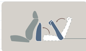
座面が跳ね上がると同時に背もたれが倒れる
