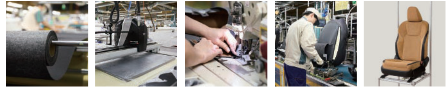
① Material(素材) ② Cutting(裁断) ③ Sewing(縫製) ④ Assembly(組立) ⑤ Product(完成)
