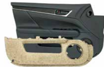
ケナフ基材を採用したドアトリム
