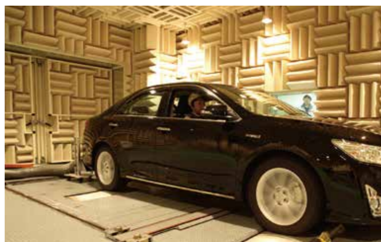
エンジン稼働時の音を予測する吸気音解析と、周波数の伝達特性を解析
