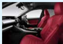
「表皮一体発泡工法」によるシートが初採用(2013年)
