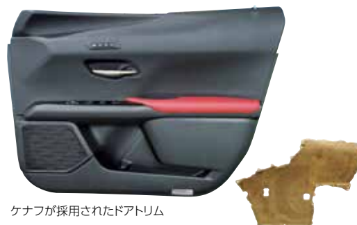
ケナフ発泡ドアトリム 基材の一部
