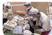
段ボールで再現した 生産工程の 現物シミュレーション
