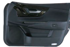
新型クラウンに搭載された高耐衝撃軽量発泡ドアトリム
