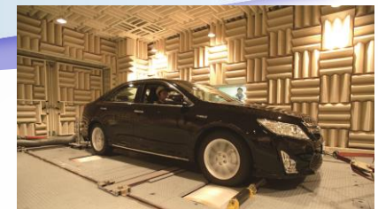
実車のNV性能 評価・解析やシミュレーションを実施
