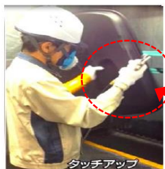
外観不良をスプレーで補修
