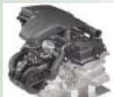
樹脂製シリンドラヘッドカバー 一体エアクリナー + 樹脂製インテークマニホールド
