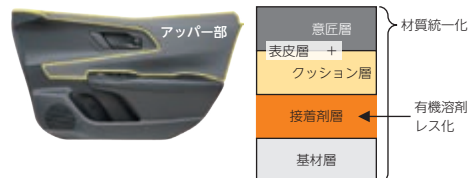
ドアトリム アップパー部の構成
